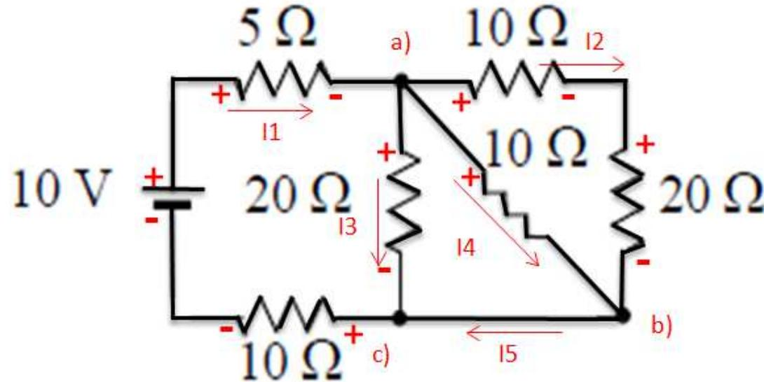
$$10 \text{ V} \cdot I_1 = 5\Omega \cdot (I_1)^2 + 20\Omega \cdot (I_3)^2 + 10\Omega \cdot (I_1)^2 + \\ + 10\Omega \cdot (I_2)^2 + 20\Omega \cdot (I_2)^2 + 10\Omega \cdot (I_4)^2$$
