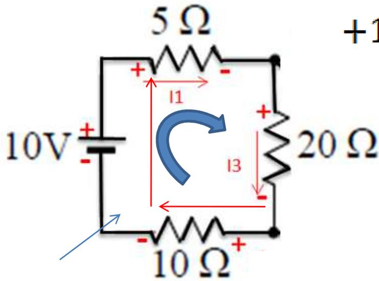
$$+10V - 5\Omega \cdot I_1 - 20\Omega \cdot I_3 - 10\Omega \cdot I_1 = 0 \quad (3)$$
